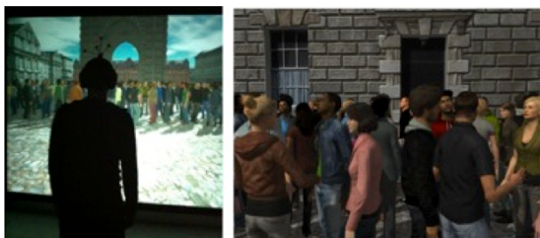
Dispositif de RV dans le studio 4 de l'Ircam. À gauche : la stéréo visuelle est projetée sur un grand écran. La mise à jour des informations visuelles et auditives est réalisée grâce à un système de suivi de position. Le sujet porte des lunettes 3D et un casque audio. À droite : exemple de scène présentant une foule d'humanoïdes.
